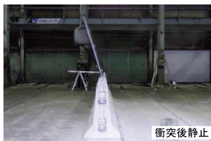
重錘衝突後の最大変形 (側面)
